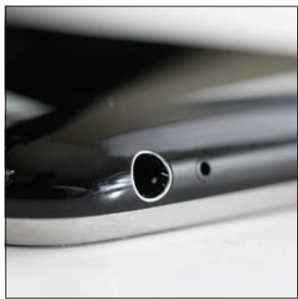
Az iPhone 3G ott van a szeren, ha zenehallgatásról van szó, így nem meglepő, hogy 3,5-es fülhallgató-csatlakozót kapott.
