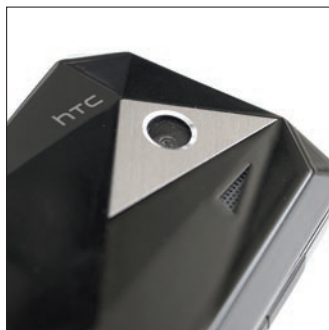
A hátlapon pihenő 3,2 megapixeles kamera meglehetősen fapados. Nincs autofókusz, és LED-vakut sem kapott.
