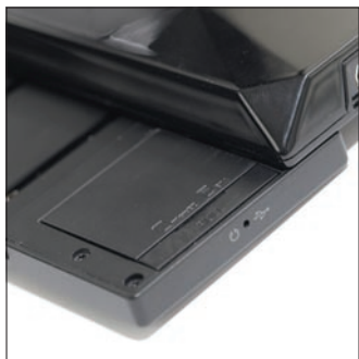
A memóriakártya foglalat egy kis „ajtó” alatt található, és szerencsétlen módon a SIM-kártya alá került.
