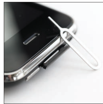
Ezzel a furcsa, hangvillára emlékeztető eszközzel lehet a SIM-kártyát tartó műanyag keretet a telefonból elővarázsolni.
